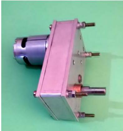
Microreductor composto por um motor de corrente contínua de ímãs permanentes acoplado ao redutor modelo G.
